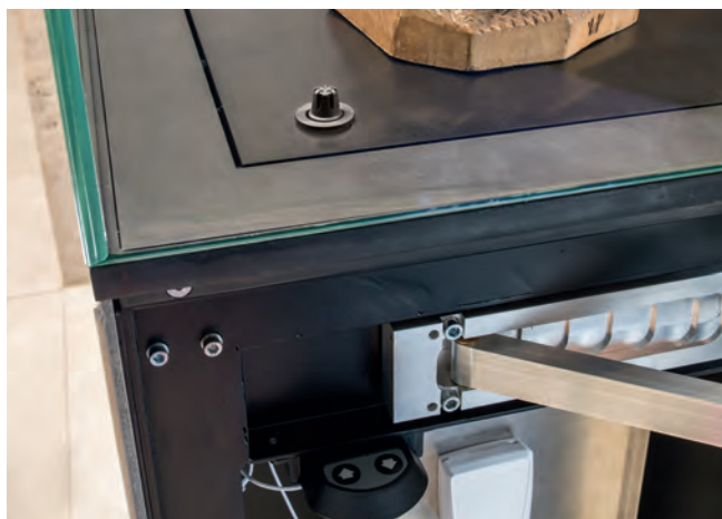
Obr. 2. Praktické: nenápadná externí sonda přímo ve vitrině, záznamník dat je schován v podstavci vitríny.
