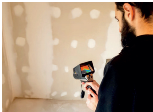
Lokalizace a analýza tepelných mostů pomocí termokamery.
