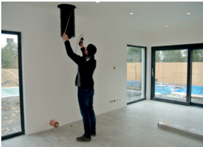
Anemometr testo 440 zvládne zkontrolovat netěsnosti i systémy vzduchotechniky.
