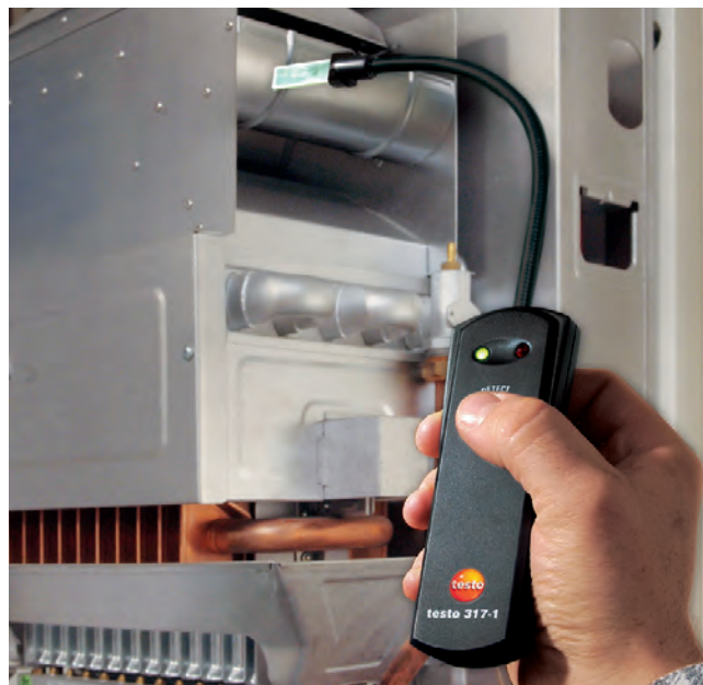
Použití detektoru zpětného tahu testo 317-1
