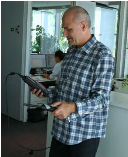
Obr. 3: Měření prostorové teploty a vlhkosti vzduchu pomocí měřicího přístroje testo 480.
