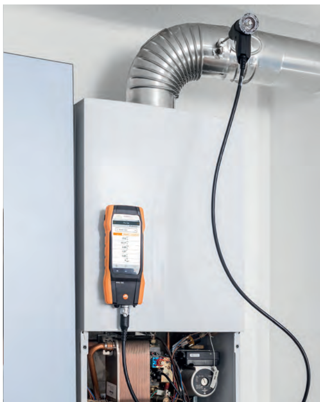
Pro seřizovací práce je nezbytný analyzátor spalin např. testo 300.
