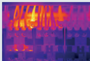
Údržba zařízení: rozpoznání příliš vysokých teplot na pojistkách a elektrických součástkách dřív, než dojde k výpadkům.
